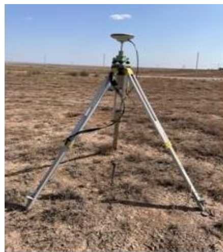
25 Сурет - GNSS қабылдағышы GS 16-ның көмегімен пункттердің координаталарын анықтау
