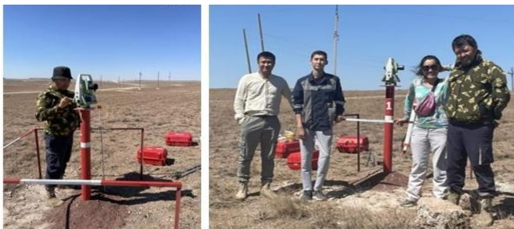
26 Сурет - TS 15 автоматтандырылған тахеометрімен жұмысты жүргізу
