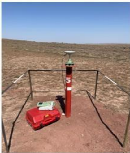
25 Сурет - GNSS қабылдағышы GS 16-ның көмегімен пункттердің координаталарын анықтау
